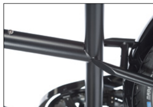
Eine zusätzliche Strebe versteift den klassischen Stahlrahmen.
